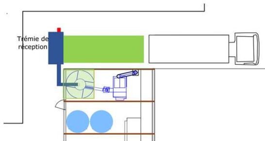
**2** Les plaquettes sont acheminées du container vers un stock tampon de 11 m<sup>3</sup> grâce à un système de vis sans fin. Ce stock laisse le temps de remplacer le container quand il est vide
